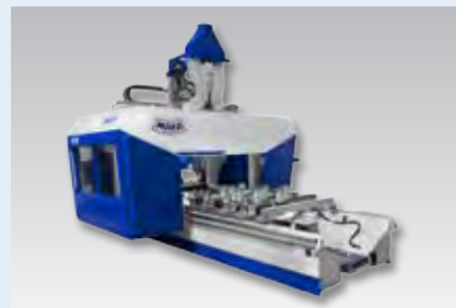
Обрабатывающий центр с ЧПУ для дерева, пластика и композитных материалов Источник: MAKA Systems GmbH
